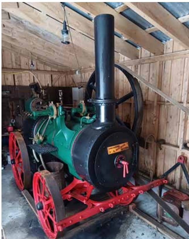
Den originale damp lokomobilen fra 1907 driver maskineriet i fabrikken.
